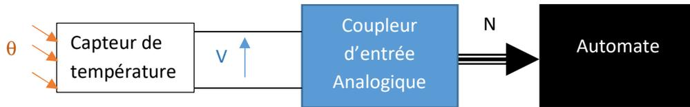
Question 1 : donner la formule qui relie la température à la tension de sortie du capteur ( $V = f(\theta)$  avec V en Volt et  $\theta$  en  $^{\circ}\text{C}$ )
