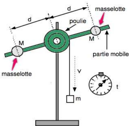
Deux masselottes de masse  $M$  sont disposées de part et d'autre de la partie mobile à la distance  $d$  de l'axe de rotation (centre de la poulie).
